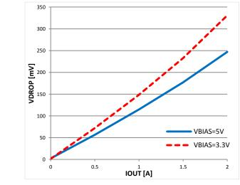
V<sub>DROP</sub> vs. V<sub>BIAS</sub> @ V<sub>OUT</sub>=1.2V
